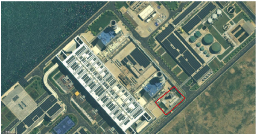
图 8 华能洋浦天然气联合循环电厂总平面图及二氧化碳捕集平台位置（红色标注区域）该平台与电厂同步设计。
