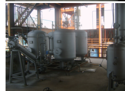
图 4.4 CO 2 和甲醇直接合成 DMC 连续式固定床催化反应器 (左) 与中试设备 (右)
